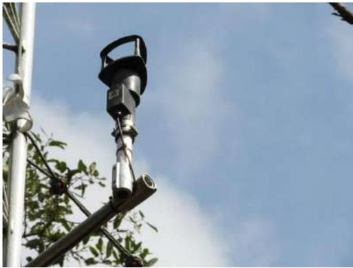
**Figura 2.** Anemómetro ultrasónico utilizado para medir la velocidad y dirección del viento.
