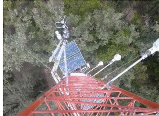
**Figura 3.** Imagen desde arriba mostrando el anemómetro sónico, el sensor infrarrojo y demás equipos colocados en la Torre JZ,
